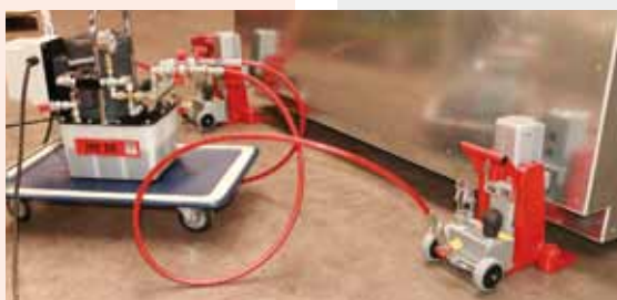
Elektropumpe JPE 30 NVR mit 2 Hebegeräten im Einsatz
